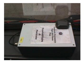
In questo modo è stato possibile predisporre con un costo minimo (presa 12 Volts e antenna a tetto) un congruo numero di mezzi su cui installare il sistema. A seconda del tipo di emergenza i box vengono quindi spostati sui mezzi che operano in quel momento rendendo così completamente monitorabile ogni tipo di emergenza.
