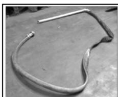
Figura 6a. Tubazione flessibile e lancia di carico
