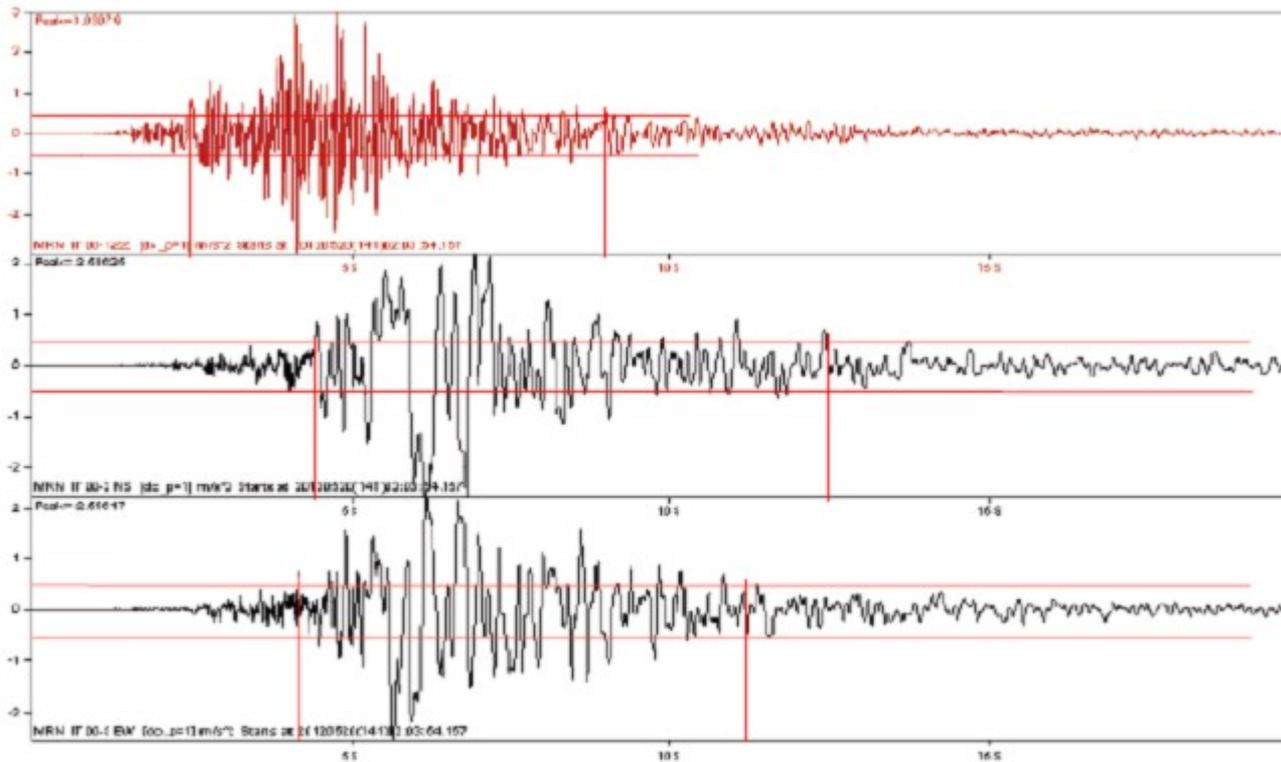
**Figura 3** - Registrazioni delle tre componenti, Up-Down, Nord-Sud ed Est-Ovest, dell'accelerazione (in  $m/s^2$ ) in corrispondenza della stazione di Mirandola durante l'evento 11 (vedi Tabella1) ([www.ingv.it](http://www.ingv.it)).
