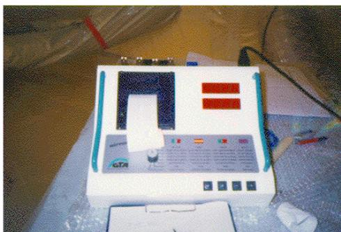
Figura 3 – Strumento per la misura, la registrazione e la stampa delle depressioni differenziali
