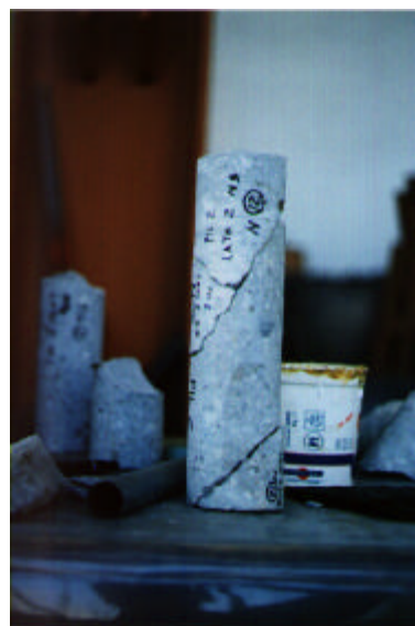
Figura 9: carota estratta da pilastro danneggiato capannone industriale in Porcari (Lu)
