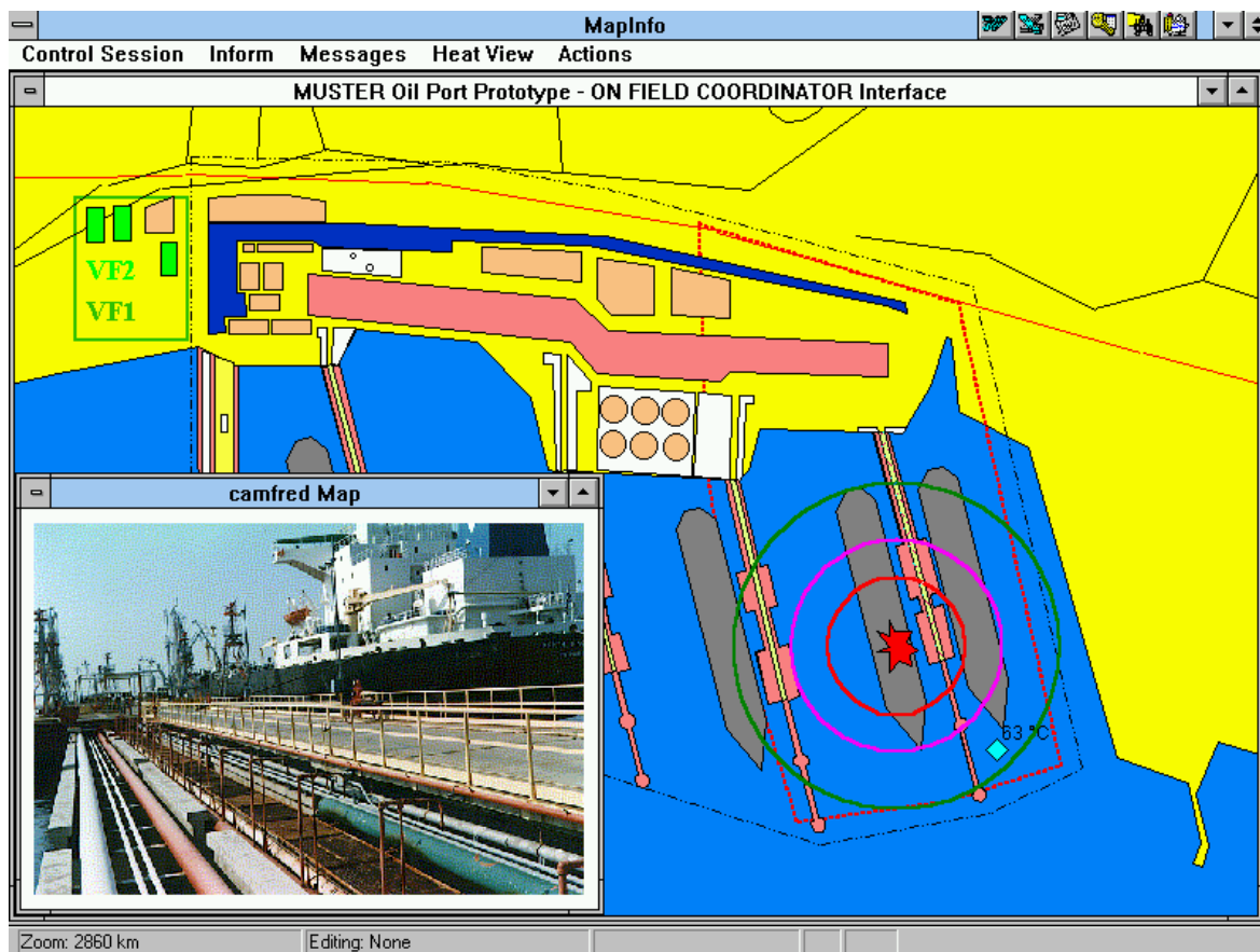
Figura 8. Curve di irraggiamento e foto impianto antincendio fisso.
