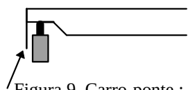
Figura 9. Carro-ponte : fazzoletto di lamiera saldata
