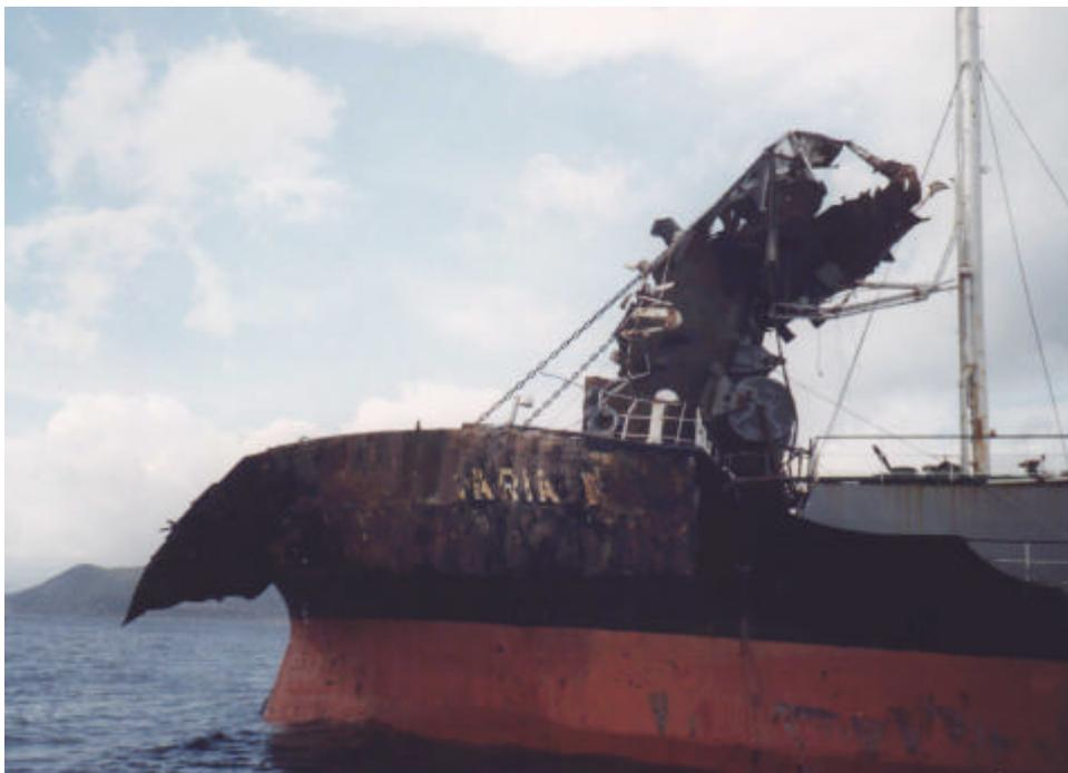
Foto 2. Vista laterale della nave con il ponte squarciato e sollevato dall'esplosione.
