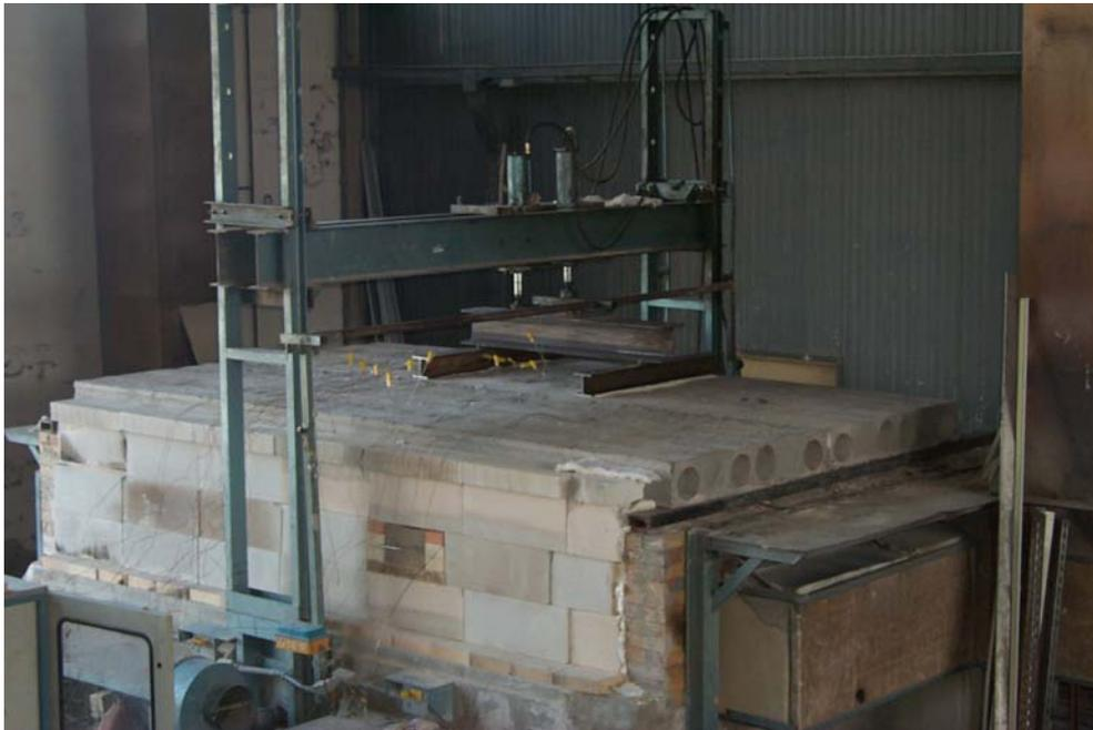
Fig. 4 Prova al forno di due lastre di solaio alveolare
