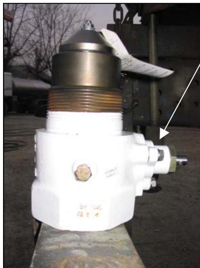
**Figura 0-4 : valvola di fondo serbatoio relativa alla fase liquida**
