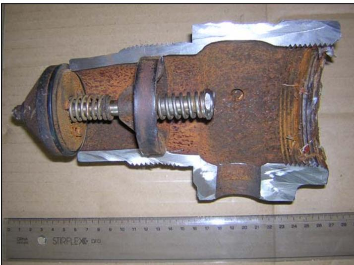
**Figura 0-4 : sezione della medesima valvola deformata ; si noti l'anello di supporto del meccanismo di chiusura automatica.**
