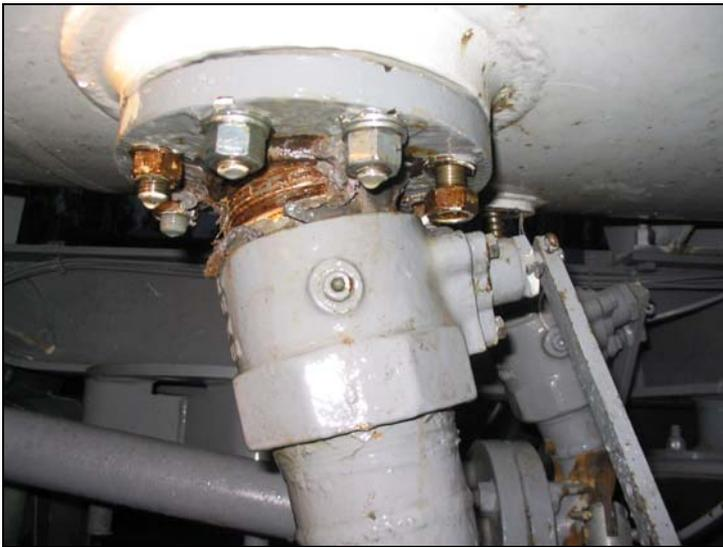
**Figura 0-3 : immagine di una valvola di fondo serbatoio deformata impropriamente a causa di un incidente.**
