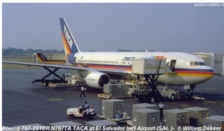
Fig.4 caricamento containers su Boeing 767 -cargo
