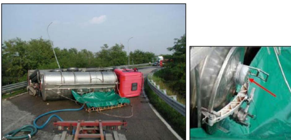
Fig. 5.1 – Ribaltamento di autocisterna avvenuta a Castelfranco Veneto (22/9/2004) e particolare della perdita proveniente dalla valvola di aerazione e sicurezza.
