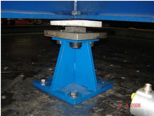
Fig. 8- Isolatore elastomerico installato
