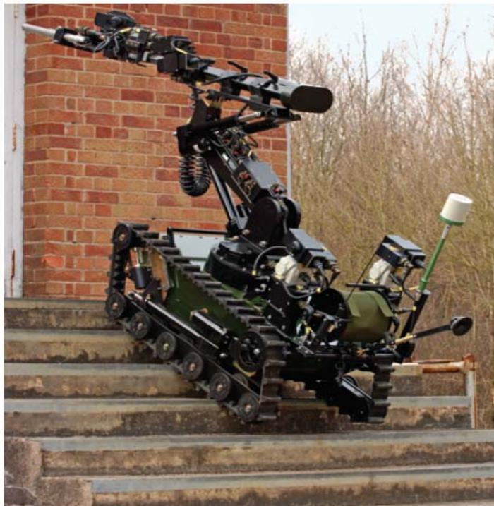
Figura 1. Robot mod. Wheelbarrow Revolution della ditta REMOTEC testato per impieghi NRBCE
