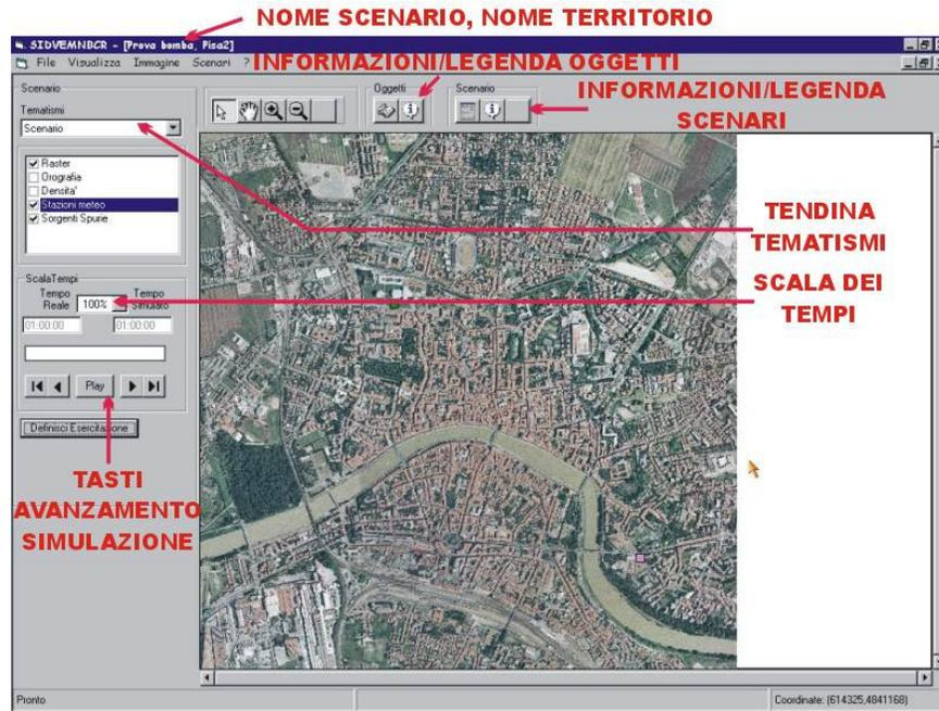
Figura 3 - Finestra di visualizzazione della simulazione
