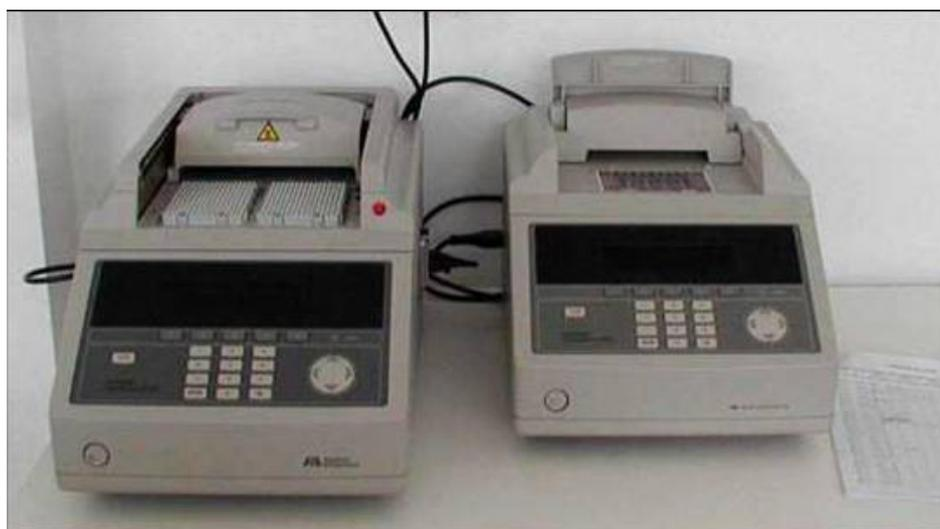
Figura 1. Termociclistori per PCR, utilizzati presso il laboratorio di Biotecnologie dell' IZS di Torino
