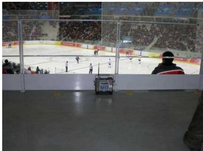
Figura 8. Strumento AreaRAE per monitoraggio dei siti
