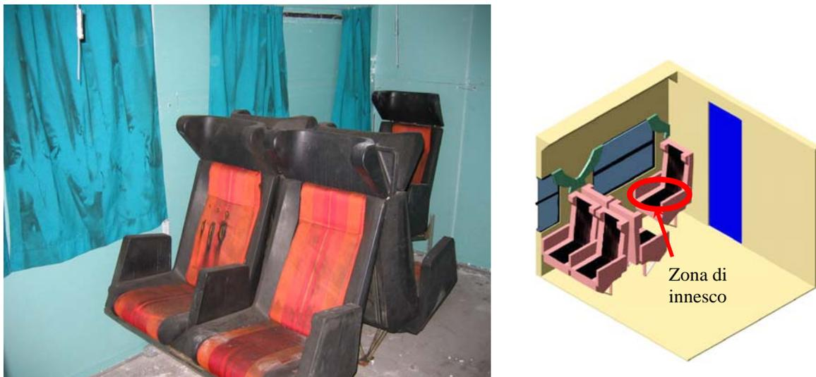
Figura 2. Interno della sezione di prova e ricostruzione 3D dell'interno del compartimento
