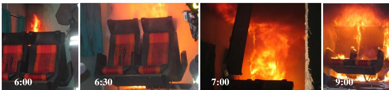
Figura 5. Istantanee tratte dalle riprese video dell'esperimento in scala reale. L'intervallo di tempo trascorso dall'innesco è indicato nella parte inferiore sinistra di ciascuna immagine.
