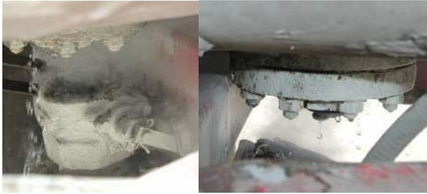
Fig. 4: Otturatore interno fase liquida di un autotreno tranciato a seguito tamponamento (notare le gocce di prodotto in fase liquida che trafilano)
