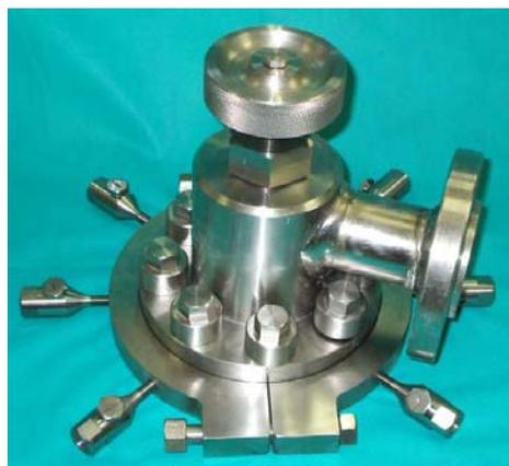
Figura 6. Speciale raccordo ad utilizzarsi in caso di rottura dell'otturatore interno con anello esterno di sigillatura con teflon liquido
