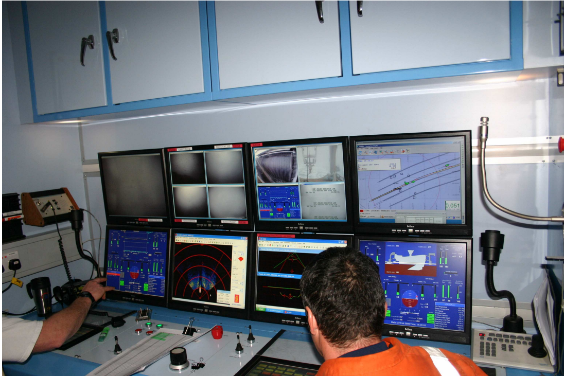
Figura 4. Sala di comando del Plough (monitoraggio in particolare della profondità e della direzione dello scavo)
