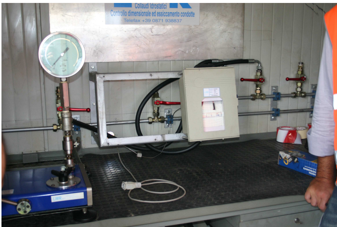
Figura 10. Strumentazione per la prova idraulica
