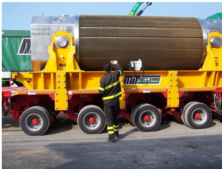
Inoltre, il personale del C.N.VV.F. effettua misure radiometriche “in campo” mediante apposita strumentazione (Figura 5). Tali misure vengono poi confrontate con quelle effettuate da altri enti (ARPA, SOGIN) e dal vettore (MITNucleare) al fine di raccogliere tutte le informazioni necessarie per la valutazione del campo di radiazioni (gamma e neutroni) durante il trasporto.
