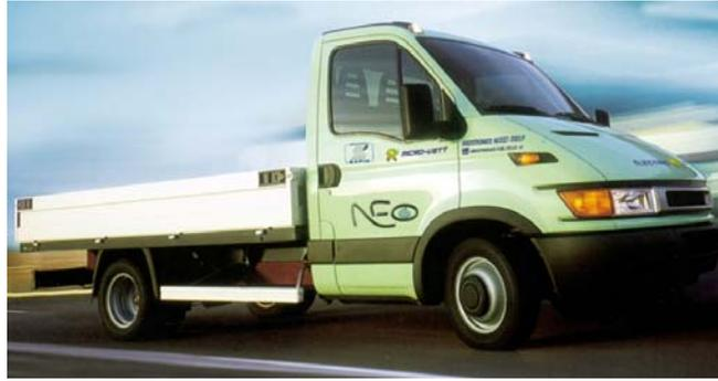
Figura 1. Veicolo con alimentazione elettrica trasformato con alimentazione idrogeno mediante cella
