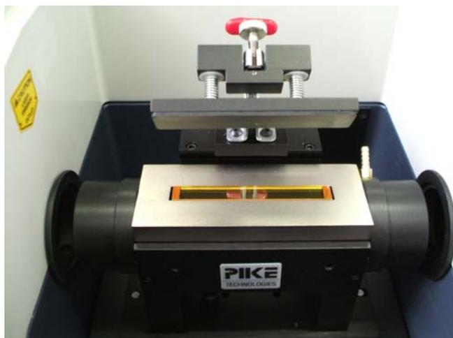
*Fig.12 Apparecchiatura con cristallo ATR*
