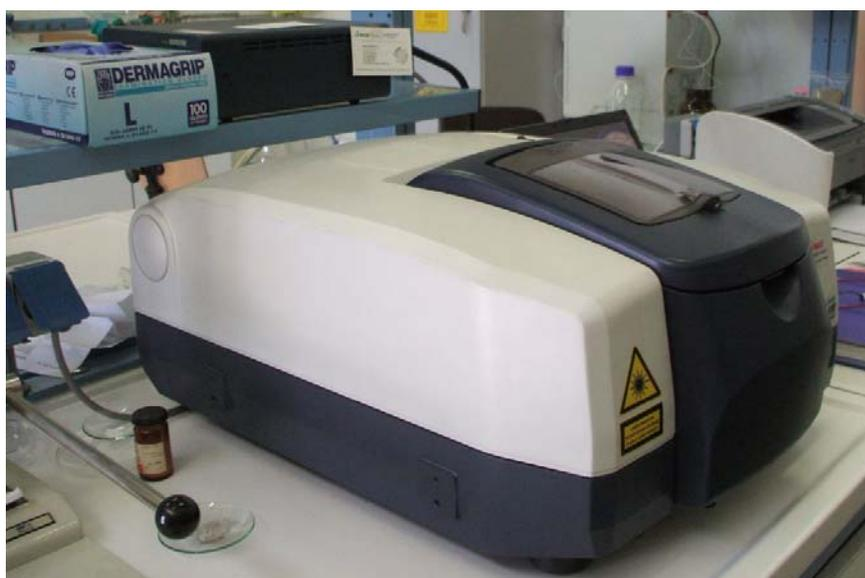
*Fig.1 Apparecchiatura FT-IR*
