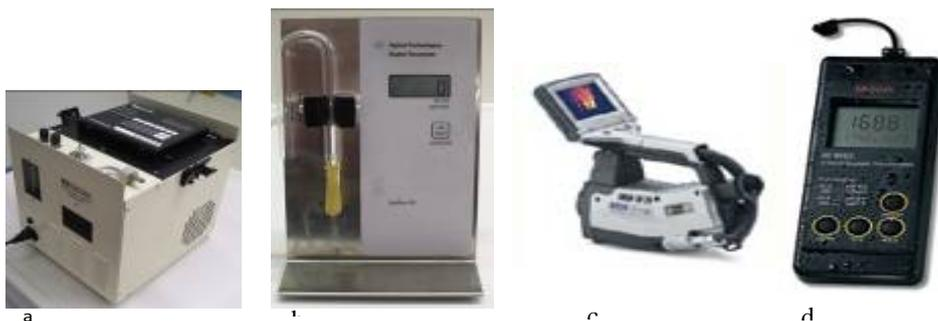
Fig. 4 Immagini della strumentazione “a” pompa Tecora Bravo M2, “b” Flussimetro digitale Agilent, “c” Termocamera Flir mode. P60, “d” Termometro a termocoppia
