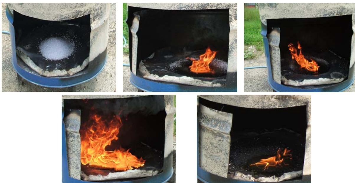
Qui sopra si mostra la successione temporale della prova di combustione, dal posizionamento del campione nella camera di combustione, all'innescò del polimero con propagazione della fiamma, fino alla fase finale quando si estingue quest'ultima ed il polimero è totalmente combusto.
