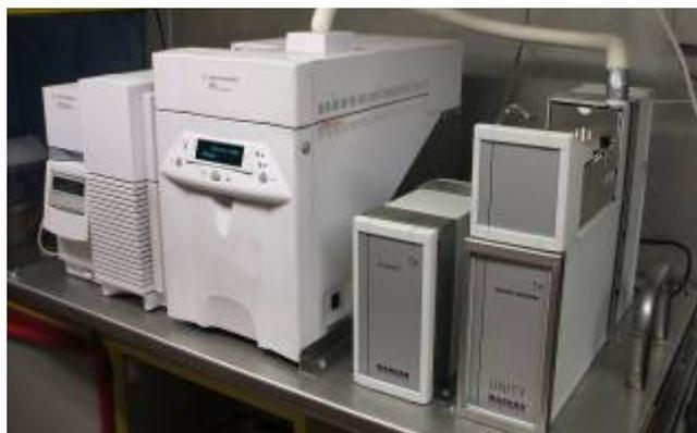
Una tale tecnica analitica si presta bene alla individuazione dei prodotti di combustione di materiali polimerici, nel caso in esame dei quattro campioni di plastiche. L'individuazione di tali prodotti consente di ipotizzare i meccanismi con cui avviene la degradazione e quindi comprendere i limiti e le pericoli di impiego di queste sostanze.
