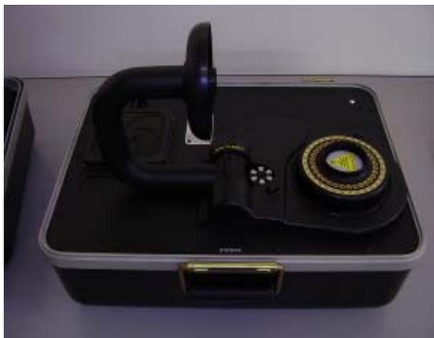
Figura 7 RT-PCR campale e campionatore d'aria portatile
