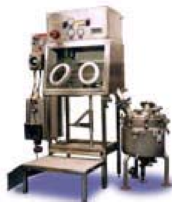
Figura 5. Isolatore con tramoggia intermedia
