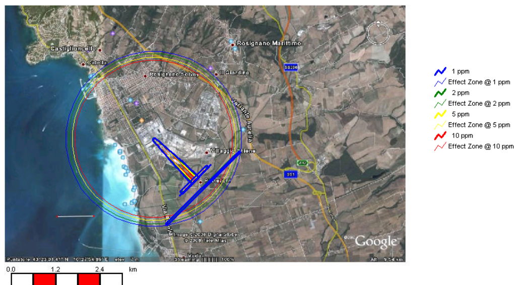
Figura 3. Transitorio di una nube di cloro da Coro-soda in F2, con averaging time=600s, height=1.5m, dopo circa 1200 s dall'inizio del rilascio. Si notano due piccole nubi del flash iniziale e l'instaurarsi del plume del quasi-stazionario che il fenomeno di maggiore persistenza e pericolosità. I cerchi rappresentano l'involuppo delle distanze di danno al variare della direzione del vento.
