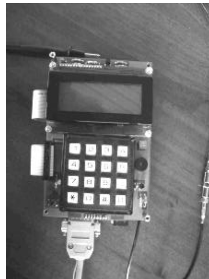
Figura 2. Pannello riprodotto il cruscotto di un veicolo pesante utilizzato per la messa a punto degli apparati di bordo e della centralina.
