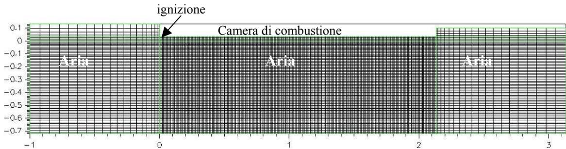
Figura 6. Tipologia di griglia utilizzata per la simulazione della fiamma stratificata con  $m=22$
