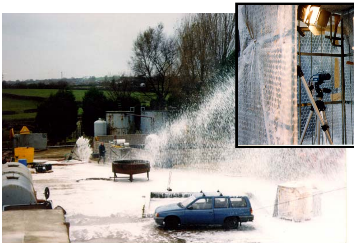
Figura 4: Apparato sperimentale per la caratterizzazione dei fiocchi di schiuma
