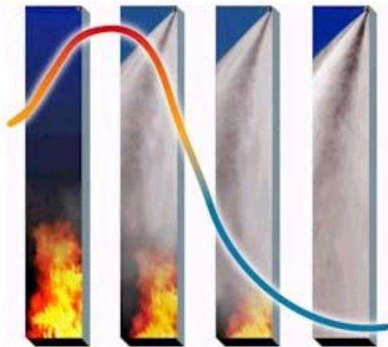
**Inertizzazione:** L'effetto di inertizzazione segue l'evaporazione stessa dell'acqua che, producendo vapore in misura circa 1.700 volte superiore al volume del liquido, introduce nell'ambiente un inerte a tutti gli effetti che contribuisce in modo sostanziale al controllo dell'incendio.
