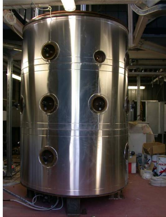
Fig. 1 – Generatore di Calore: in evidenza gli alloggiamenti per le termoresistenze sulla superficie laterale
