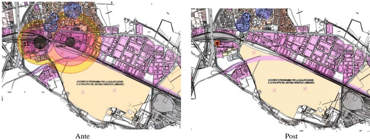
Figura 6: confronto fra le aree di danno prima e dopo l'elaborazione del RIR (lato est)
