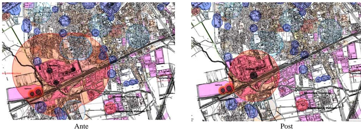
Figura 5: confronto fra le aree di danno prima e dopo l'elaborazione del RIR (lato ovest)
