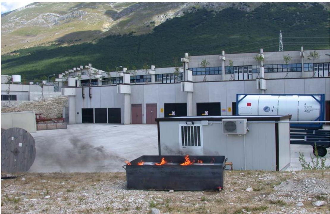
*Figura 7 - Prova di bruciamento con mattonelle di FOAMGLASS*
