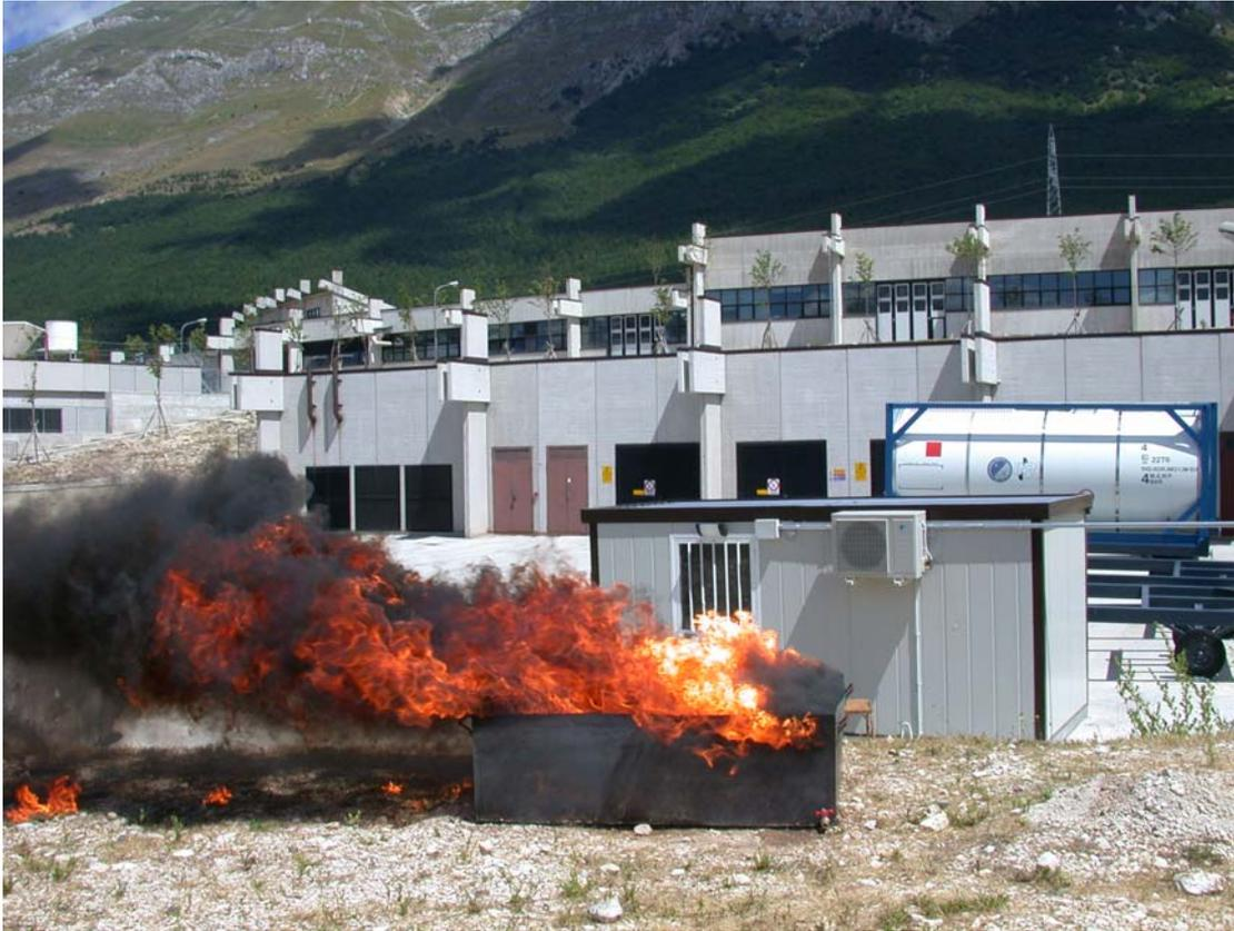
*Figura 6 - Prova di bruciamento senza mattonelle di FOAMGLAS*
