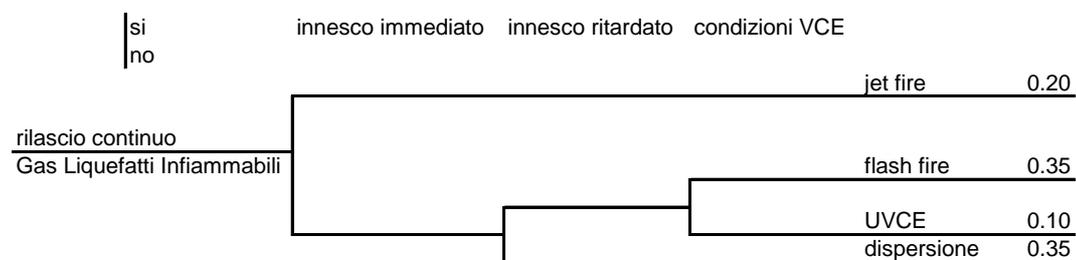
**Figura 4:** albero degli eventi per un rilascio continuo di gas liquefatti infiammabili
