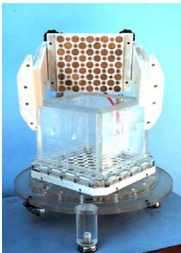
Fig.2.6 - Appareto per la valutazione della resistività elettrica dei terreni in funzione del grado di saturazione
