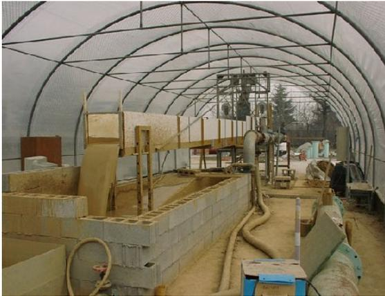
Fig 3.1 - Impianto sperimentale per la simulazione di colate di fango
