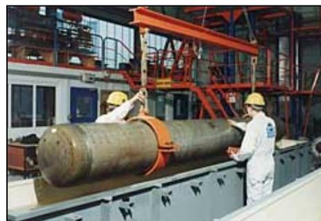
Figura 9. Stoccaggio di idrogeno tramite idruri metallici. [6]
