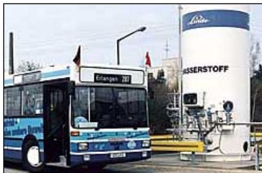
Figura 8. Stazione di rifornimento con serbatoio di idrogeno liquido. [6]
