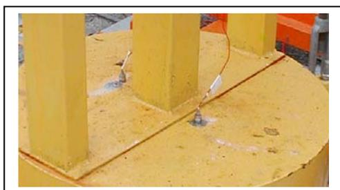
**Fig. 9:** posizione accelerometri sul grave
