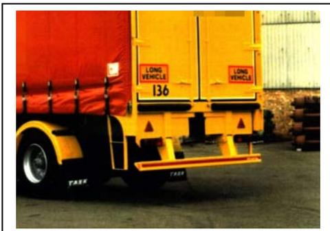
**Fig. 2.1:** esempio di una barra paraincastro posteriore
