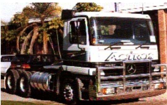
**Fig. 1.1:** Esempio di applicazione su di un autocarro del dispositivo di protezione del motore e del radiatore.
