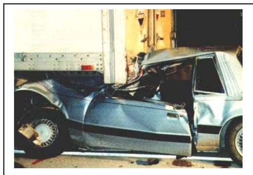
**Fig. 1.2:** risultato di un tamponamento tra autovettura ed autocarro sprovvisto di barra posteriore anti-incastro
