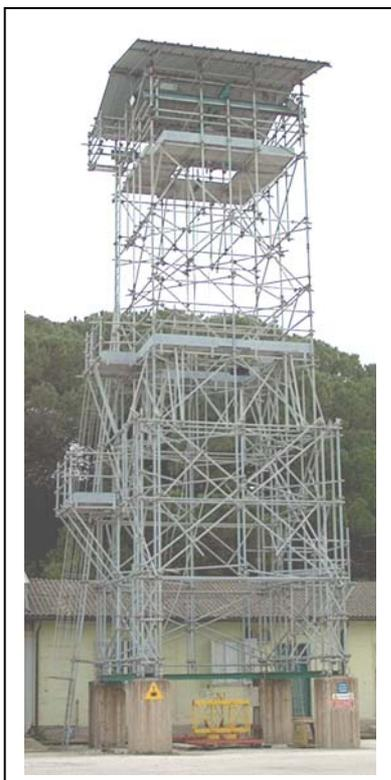
**Fig. 7:** torre di caduta del Laboratorio Scalbatraio
