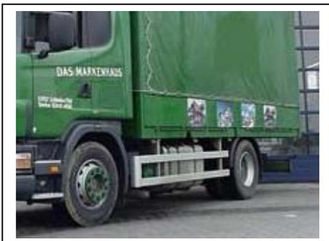
**Fig.2.2:** esempio di barre paraincastro laterali per la protezione dei veicoli a due ruote
