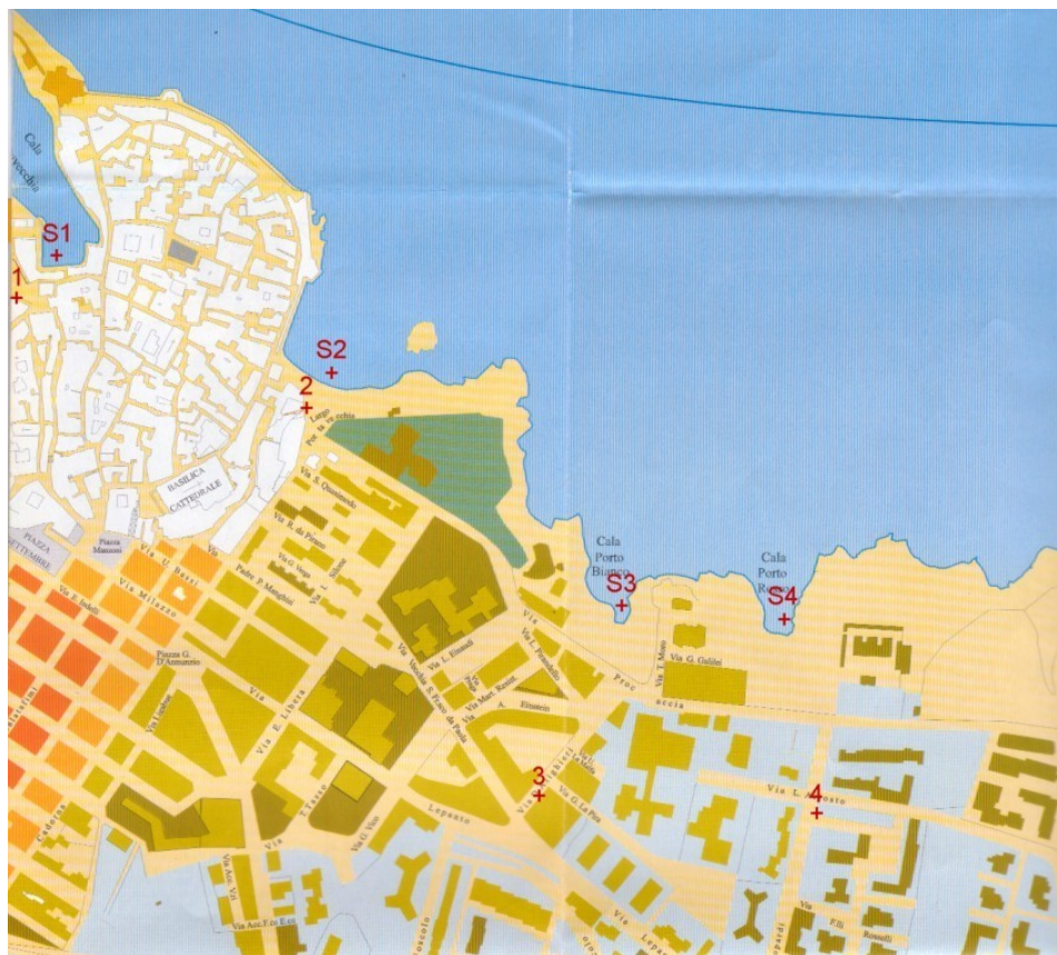
Figura 1. Sperimentazione nel comune di Monopoli: punti di misura (1, 2, 3, 4) e sonde ausiliarie di corrente (S1, S2, S3, S4).
